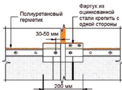
Рис. 27. Краевая рейка на стене из бетонных плит
